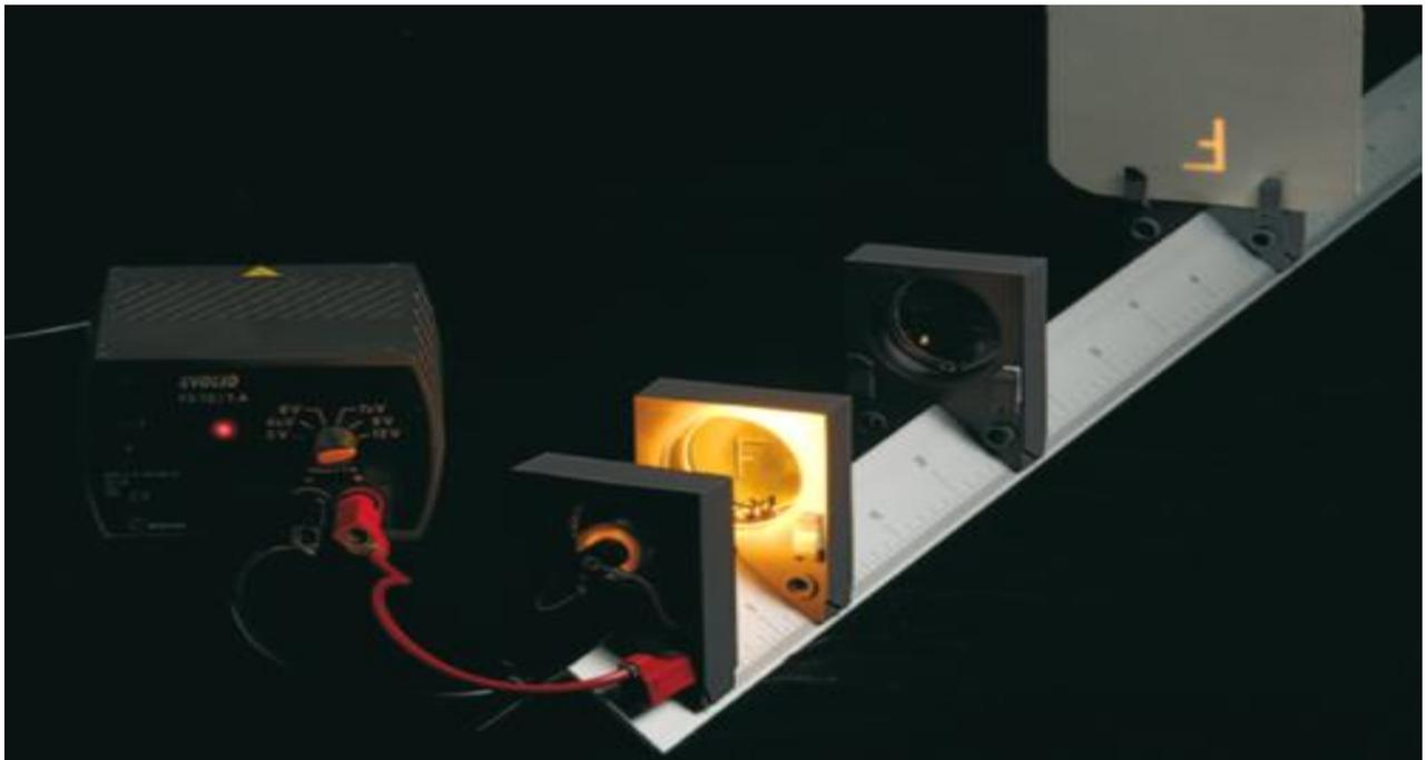
Observation : On peut obtenir l'image nette renversée d'un objet sur un écran à condition que la distance entre l'objet et la lentille soit supérieure à la distance focale.
